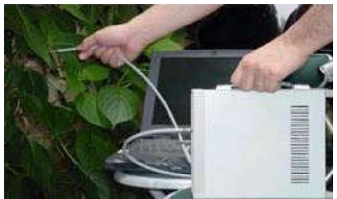
屋外でも・・・《屋外で葉の反射率測定》
