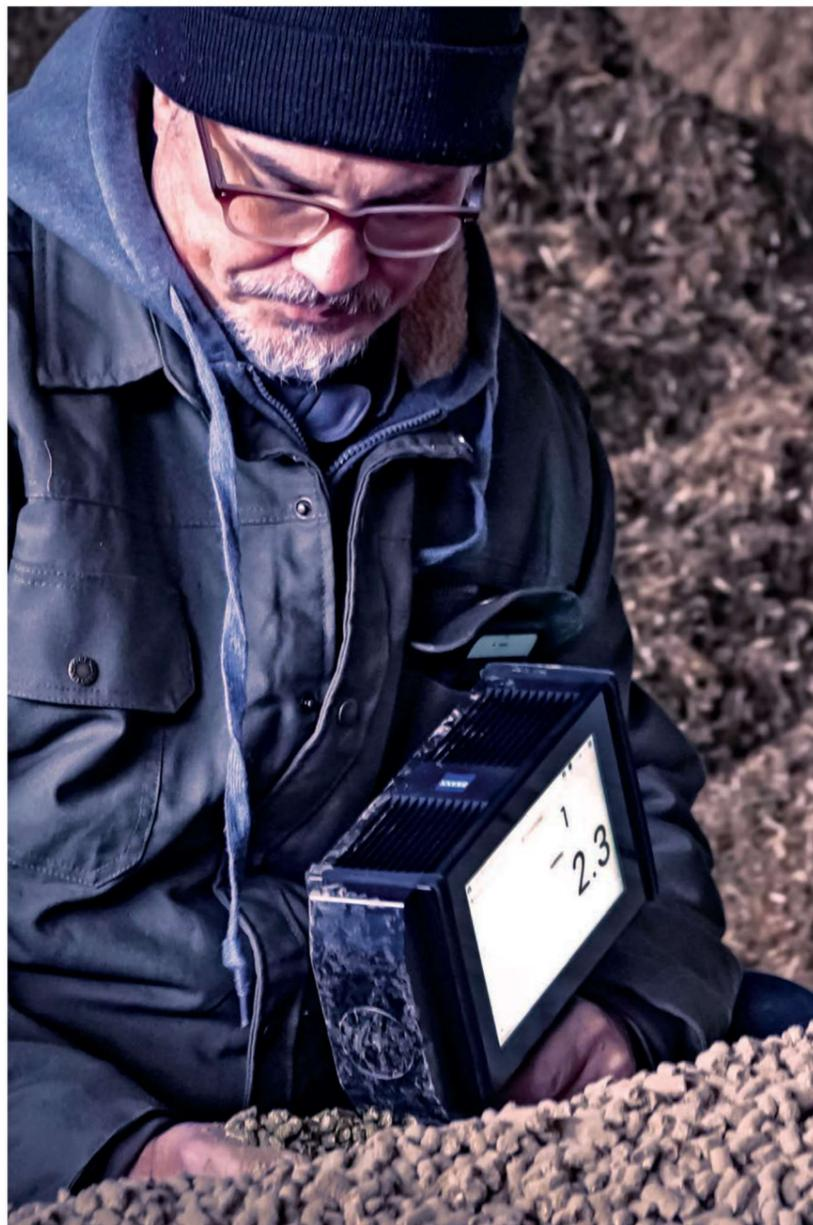
最適な飼料配合を検査する為「AURA® handheld NIR」を手に測定している農業系栄養士
